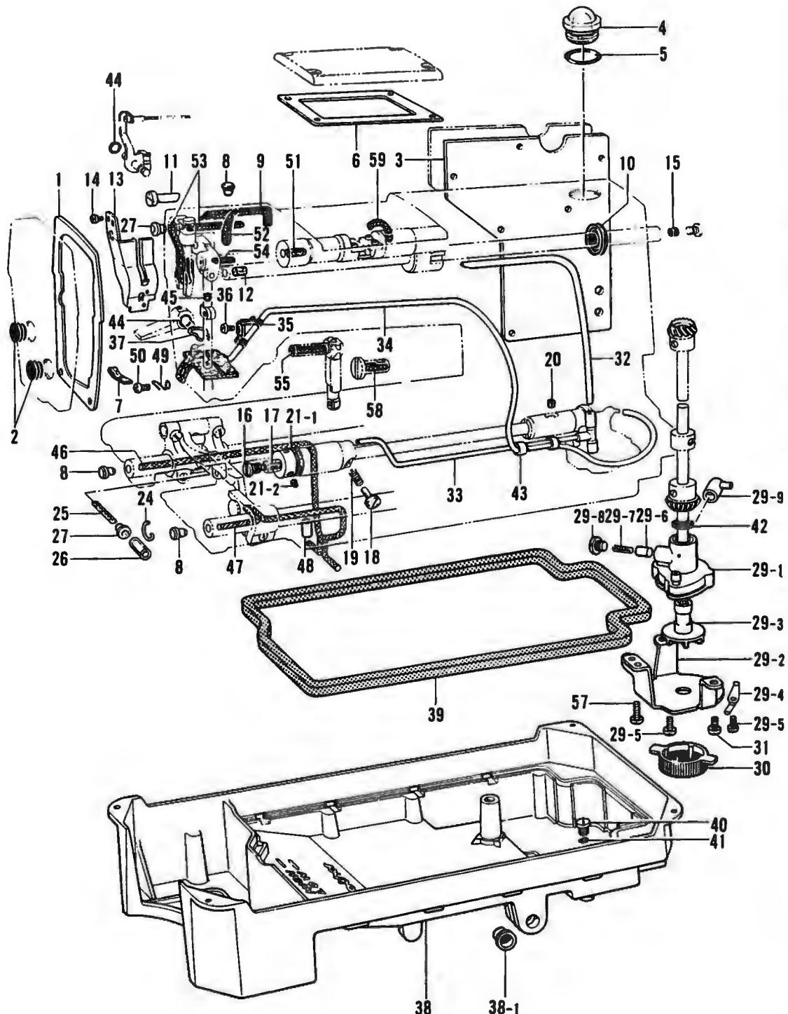
K. 給油潤滑関係 / Lubrication / Schmierung / Lubrification / Lubricación
