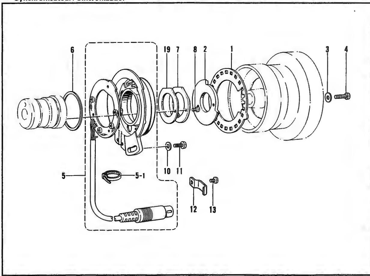
P. ヒュルメ関係 / Tension release mechanism / Spannungsverminderungsvorrichtung /
