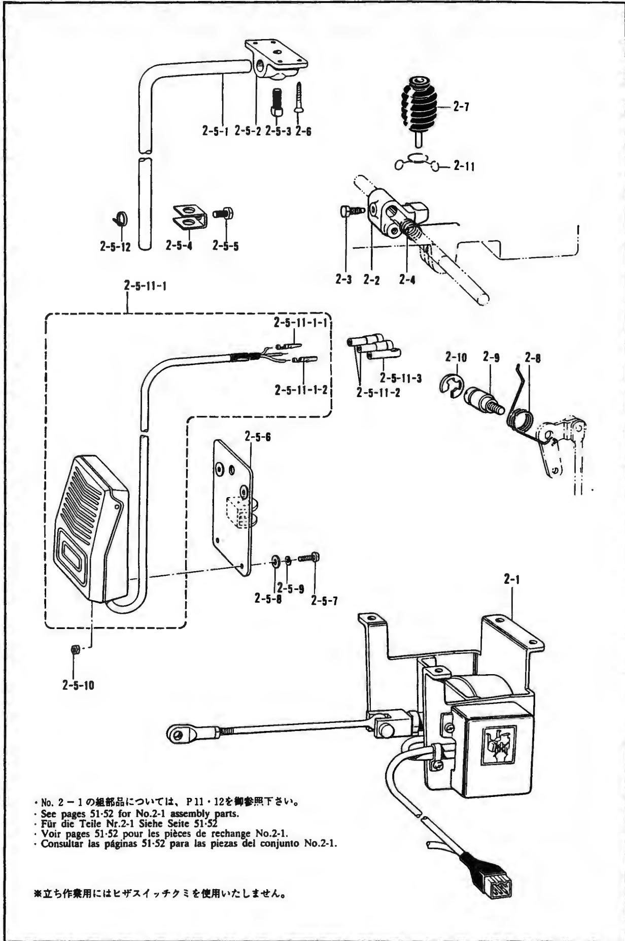
Y2. 電磁押工上部関係 <特別注文部品> / Presser foot lifting solenoid set <Option parts> /
