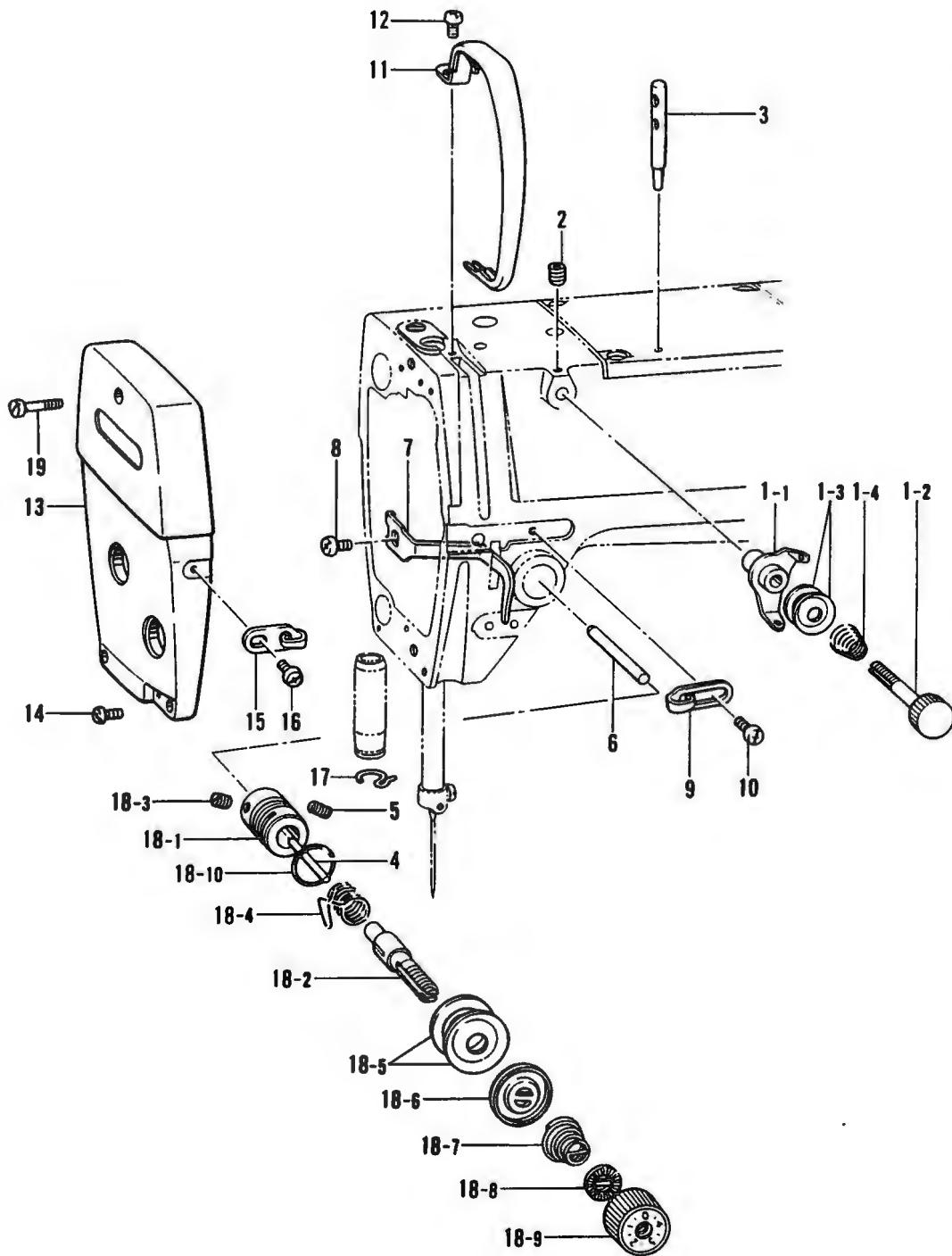
L. 糸通し関係 / Threading mechanism / Fadenführungs vorrichtung /
