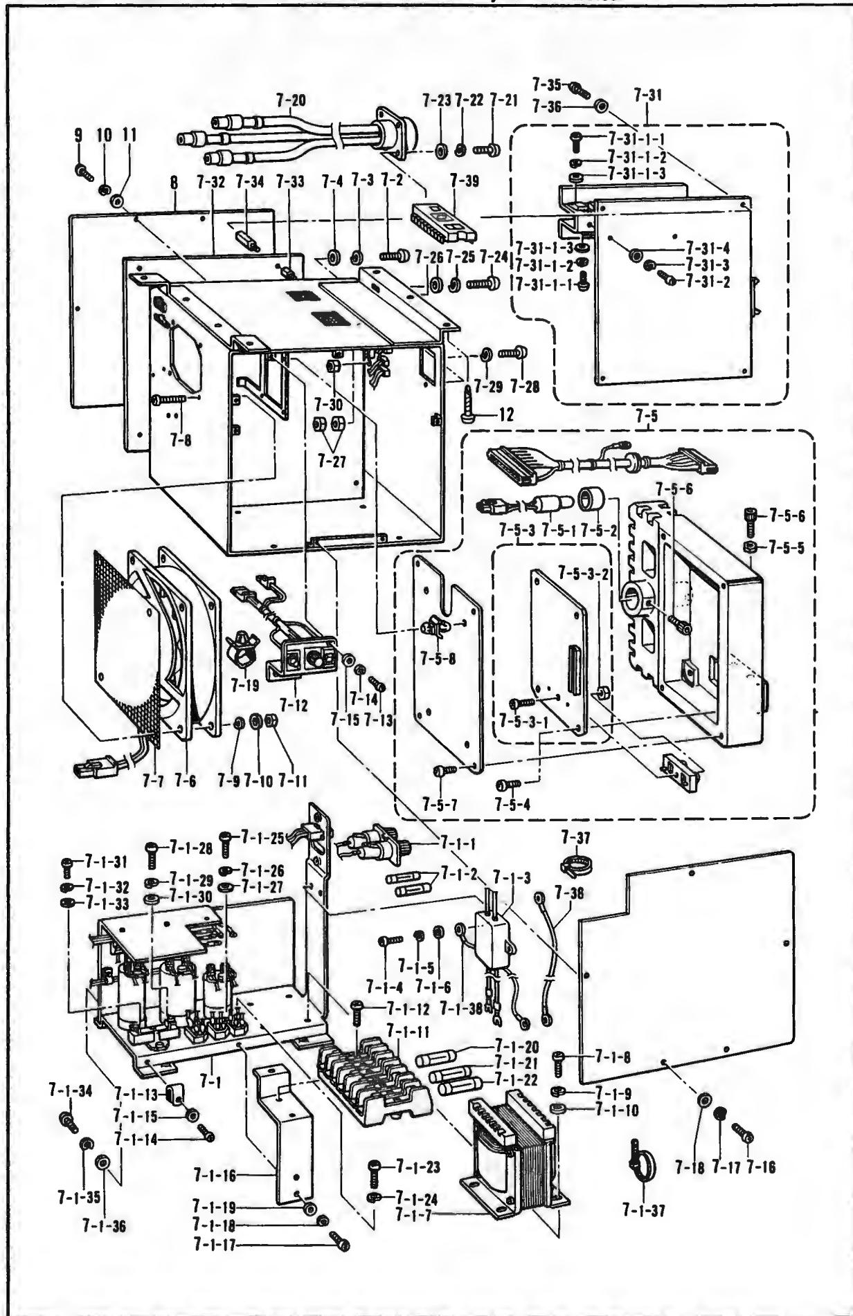
T2. コントロールボックス関係 / Control box mechanism / Schaltkasten /
