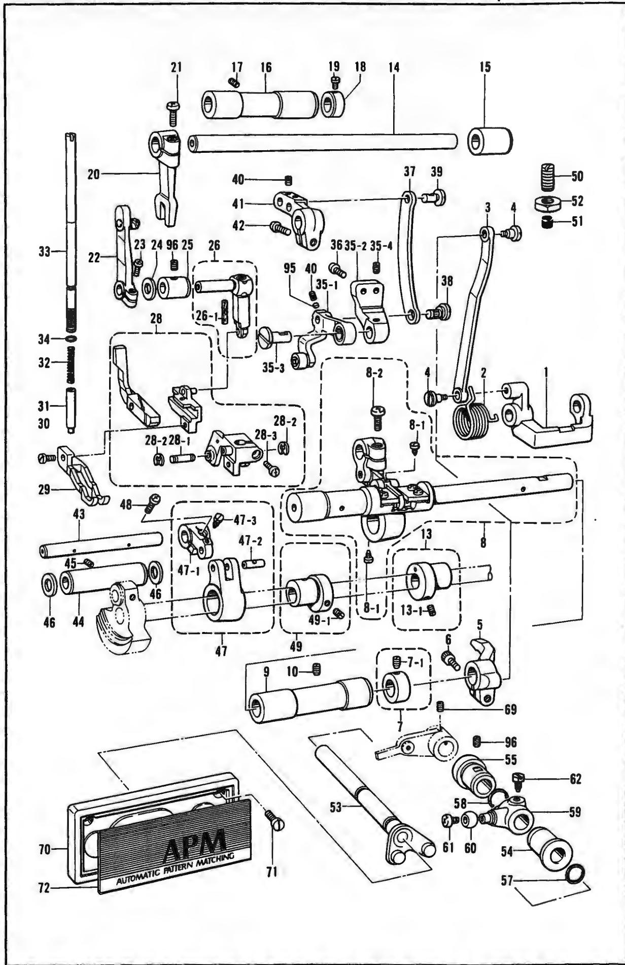
H1. 上送り関係/Upper feed mechanism/Obertrans port vorrichtung/
