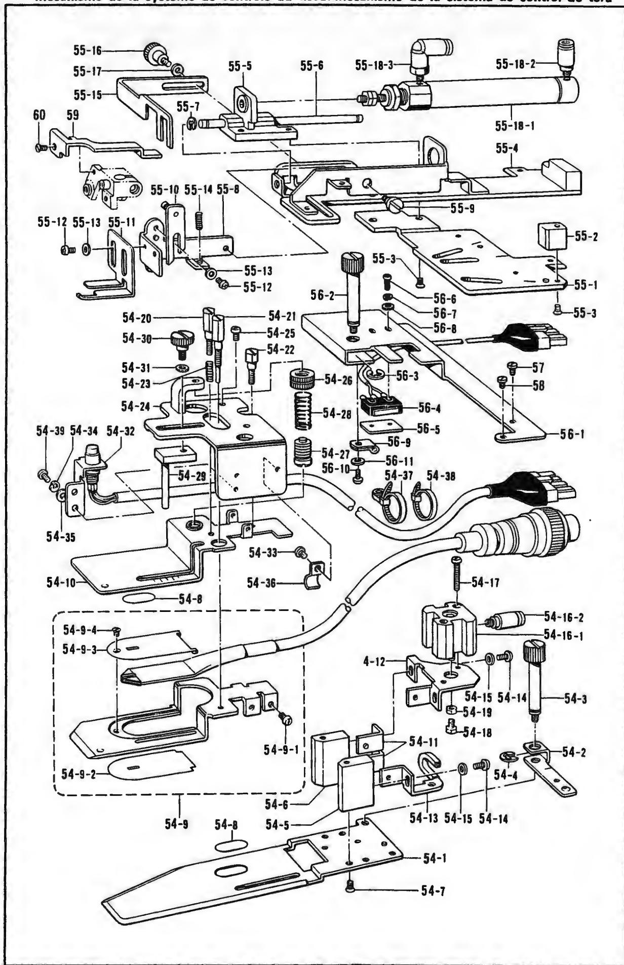
**W2. 布制御関係 / Cloth control system mechanism / Stoffführungs vorrichtung /**
