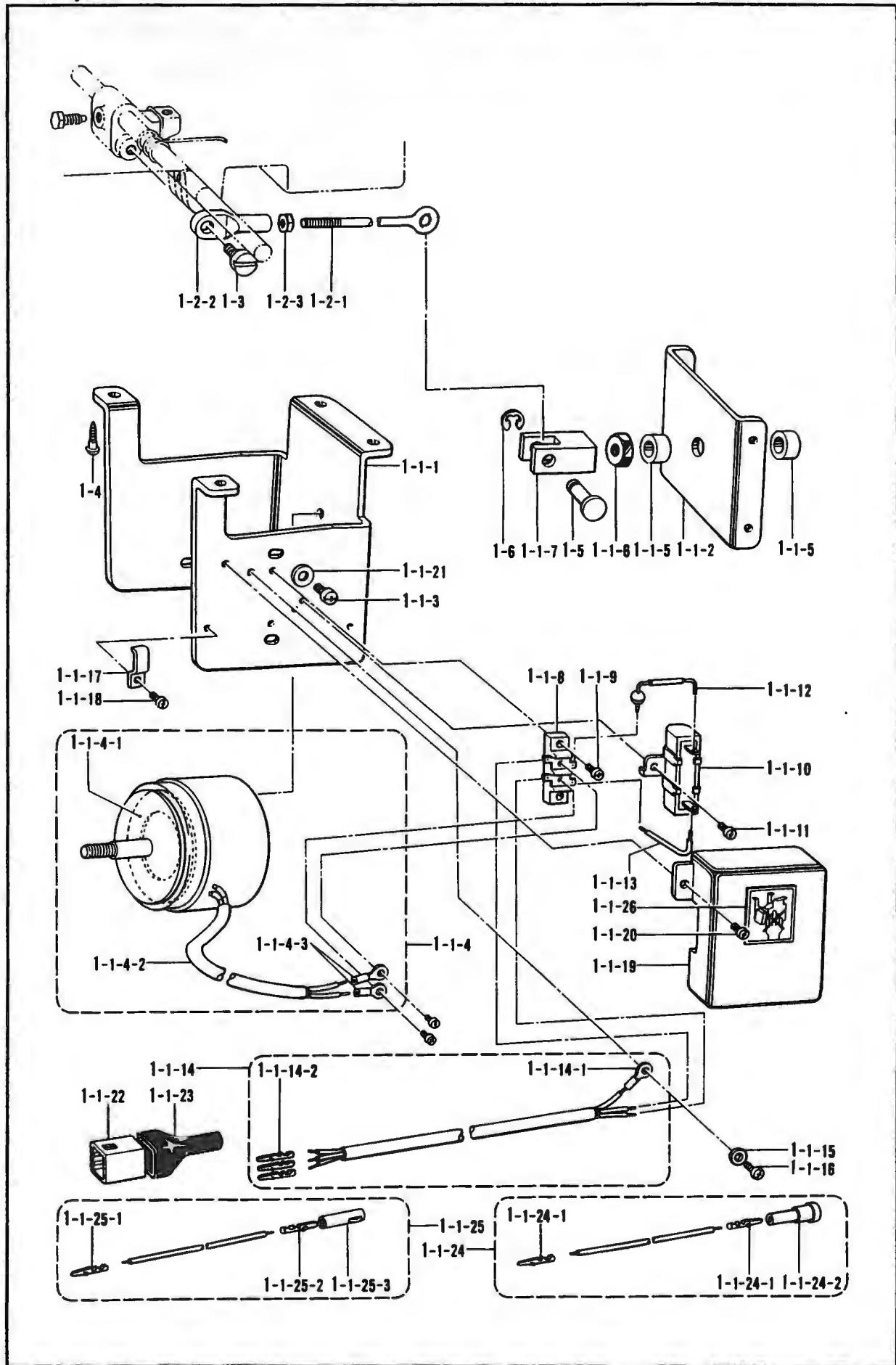
Y1. 電磁押工上ヶ関係 <-900> / Presser foot lifting solenoid set <-900> / Solenoidsatz für die Anhebung de Stoffdrückerfußes <-900> / Jeu de solénoïde du releveur du pied presseur <-900> / Conjunto solenoide del levantador del pie del prensatelas <-900>
