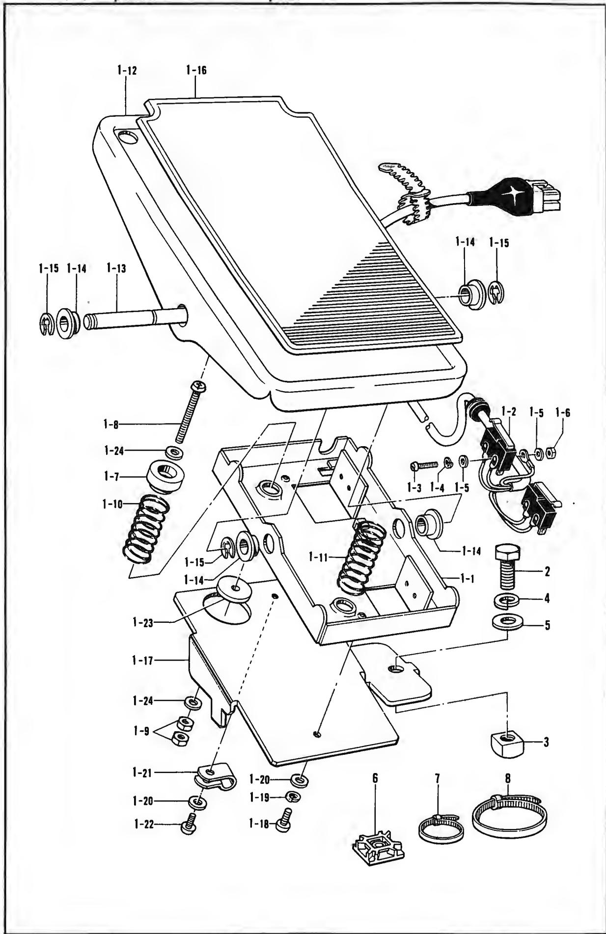
X. 踏ミ板関係 /Treadle mechanism/Fußbetätigung/
