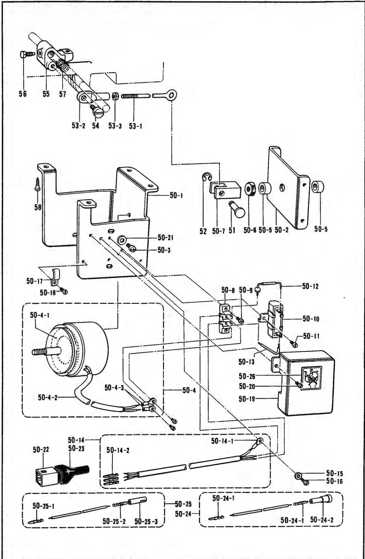
F. 押工上げ関係 <-900> / Presser foot lifter mechanism <-900> / Stoffhalterhebervorrichtung <-900> /
